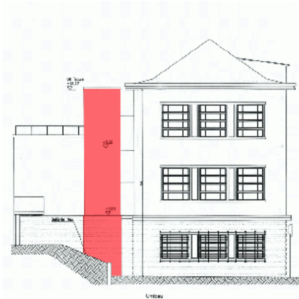
Fassadenzeichnung mit Aufzugsschacht
